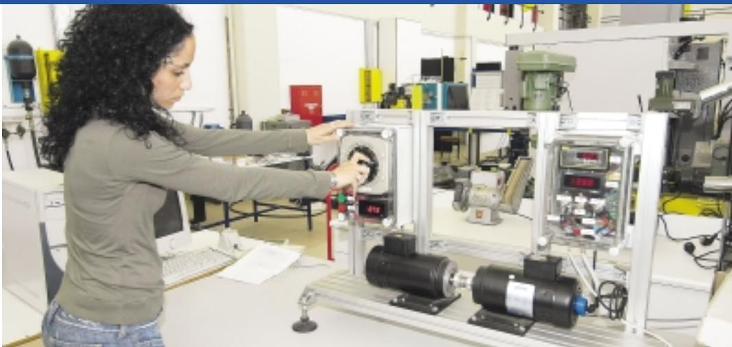
**Το εργαστήριο παρέχει τη δυνατότητα στους προπτυχιακούς σπουδαστές να ελέγχουν ακόμη και μέσω διαδικτύου εργαστηριακές εγκαταστάσεις μέτρησης χαρακτηριστικών ροπής-στροφών κινητήρων AC και DC και σερβομηχανισμών.**
