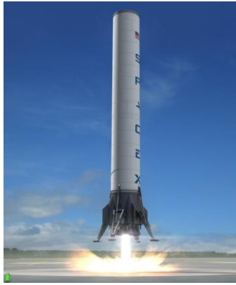
Σχήμα 3-1. (α) Έλεγχος κλίσης πυραύλου. (β) Ανάστροφο εκκρεμές.
