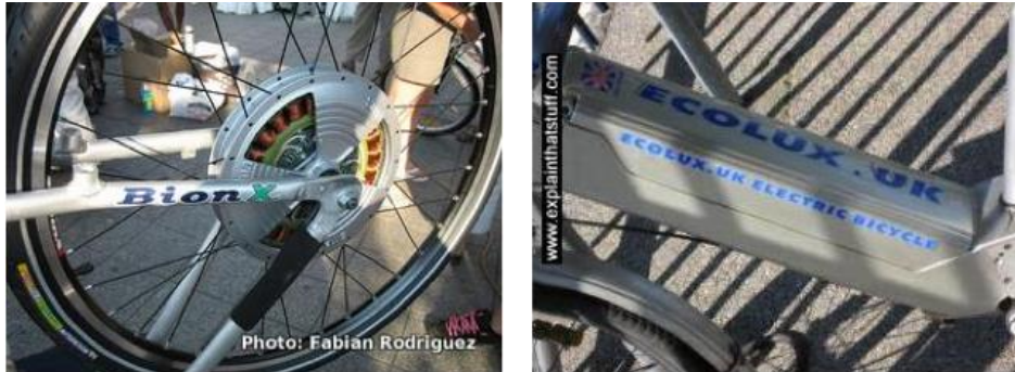
Σχήμα 1. (α) Κινητήρας ΣΡ χωρίς ψήκτρες ενσωματωμένος στην ρόδα ποδηλάτου. (β) Μπαταρία ηλεκτρικού ποδηλάτου.
