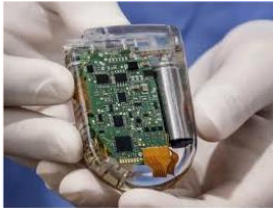
Σχήμα 1. Αντλία εμφύτευμα για έγχυση φαρμάκων. Περιλαμβάνει κινητήρα ΣΡ μικρών διαστάσεων.
