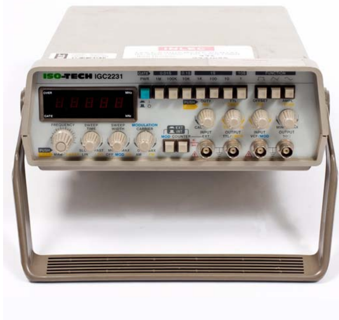
Εικόνα 4. Γεννήτρια ISOTECH IGC2231.
