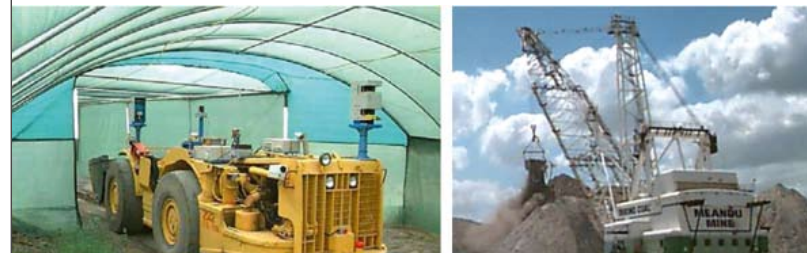
Σχ. 9. (α) Σύστημα φόρτωσης και μεταφοράς ορυκτού σε προσομοίωση κίνησης σε στοά ορυχείου. CSIRO. (β) Ο ρομποτικός εκσκαφέας του CSIRO.
