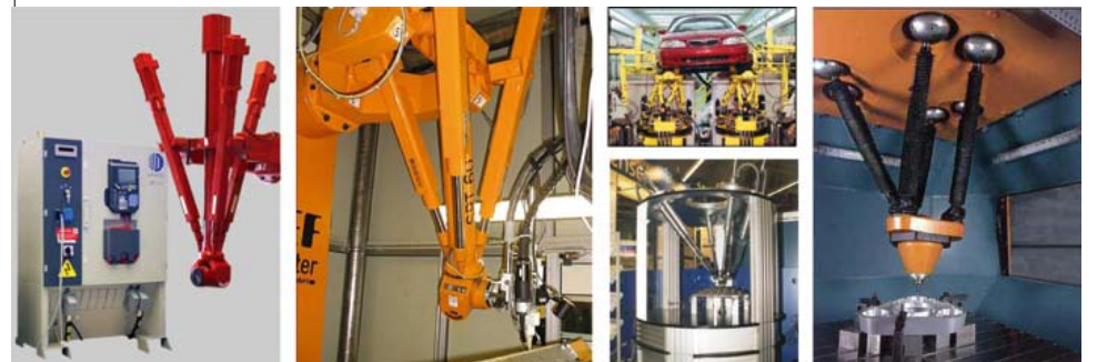
Εξ. 3. Ρομποτικός μηχανισμός Stewart σε βιομηχανικές εφαρμογές.
