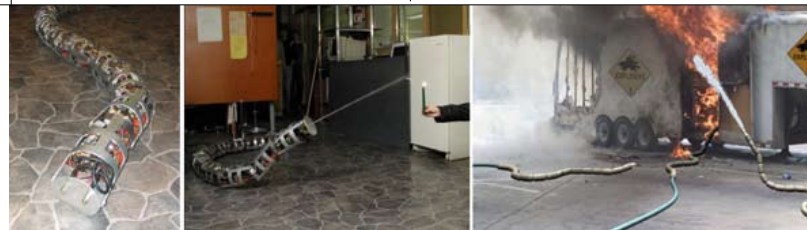
Σχήμα 8. Ρομποτική αντλία πυρόσβεσης.
