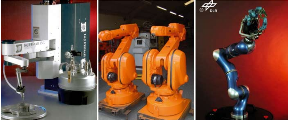
Εξ. 1. (α) Τυπικό βιομηχανικό ρομπότ SCARA, (β) βιομηχανικοί ανθρωπόμορφοι βραχίονες, (γ) ερευνητικός ανθρωπόμορφος βραχίονας με χέρι, κατασκευασμένος από το εργαστήριο του DLR στη Γερμανία.
