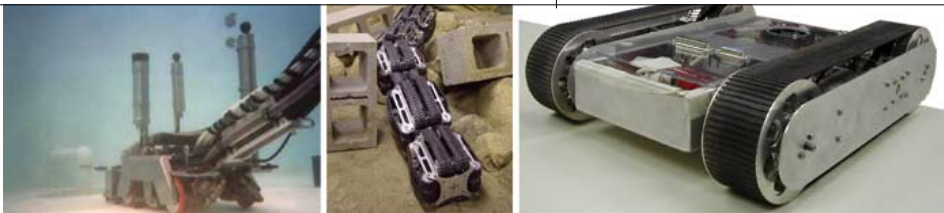
Σχ. 7. Ρομπότ επιθεώρησης. (α) Επιθεώρηση γεμάτης δεξαμενής. (β) Επιθεώρηση για δυσμενή περιβάλλοντα, (γ) Ανατρεπόμενο ερπυστιοφόρο που κατασκευάστηκε στο ΕΑΕ.
