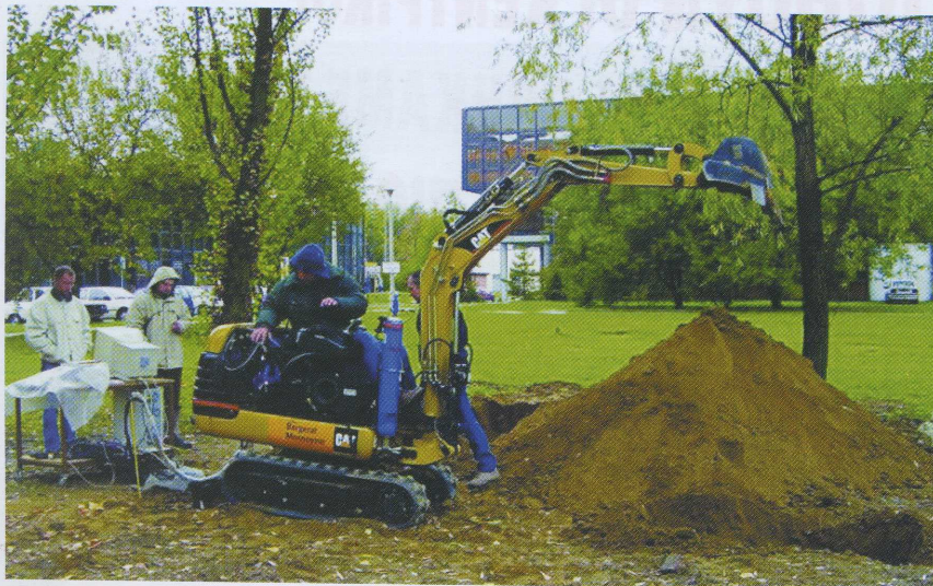
Σχ. 2. Μικρών διαστάσεων σερβοϋδραυλικά οδηγούμενος εκσκαφέας, με υδραυλικό μέσο το νερό (Fluid Power Laboratory, Institute of Machine Design, University of Technology, Κρακοβία, Πολωνία).
