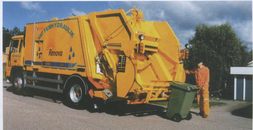
Σχ. 3. Απορριμματοφόρο που χρησιμοποιεί το νερό ως υδραυλικό μέσο για τη λειτουργία του, εξοικονομώντας 12.000 λίτρα λαδιού ετησίως (Γκέτεμποργκ, Σουηδία, Sorensen 1998).
