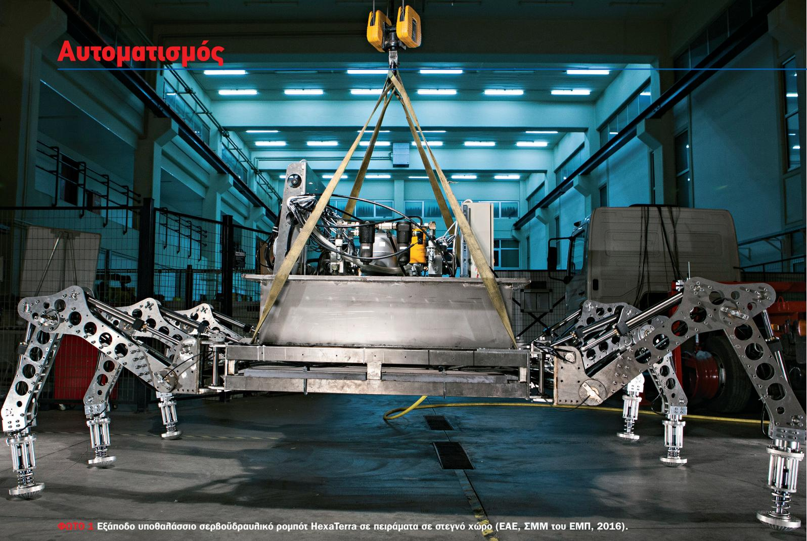
ΦΩΤΟ 1. Εξάποδο υποθαλάσσιο σερβοϋδραυλικό ρομπότ HexaTerra σε πειράματα σε στεγνό χώρο (ΕΑΕ, ΣΜΜ του ΕΜΠ, 2016).
