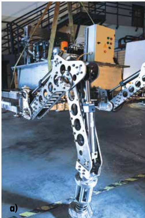
ΕΙΚΟΝΑ 5: Ένα πόδι του ηλεκτροϋδραυλικού ρομπότ HexaTerra με τους τρεις υδραυλικούς επενεργητές διπλής δράσης. α) Πραγματικό σύστημα. β) Σχεδιαστική απεικόνιση.
