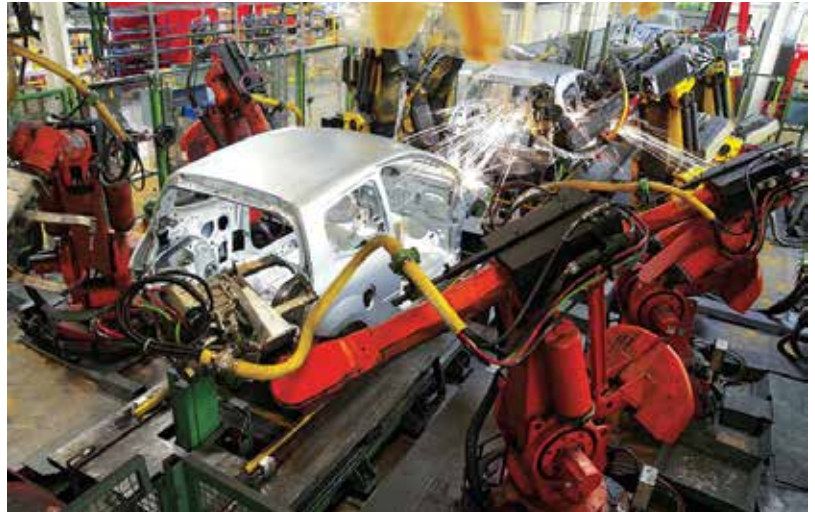
ΕΙΚΟΝΑ 1: Σύγχρονη γραμμή παραγωγής αυτοκινήτων με χρήση σερβοϋδραυλικών ρομποτικών συστημάτων.
