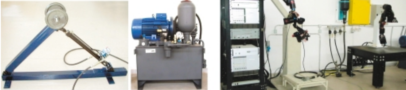
ΣΧΗΜΑ 5. Εφαρμογές ηλεκτροϋδραυλικών σερβοσυστημάτων του ΕΑΕ, Σχολής ΜΜ, ΕΜΠ. (α) Πειραματικό σύστημα ενός βαθμού ελευθερίας (υδραυλικός σερβοεπιενεργητής και υδραυλική μονάδα τροφοδοσίας), (β) Τηλερομποτικό σύστημα master-slave της SARCOS.
