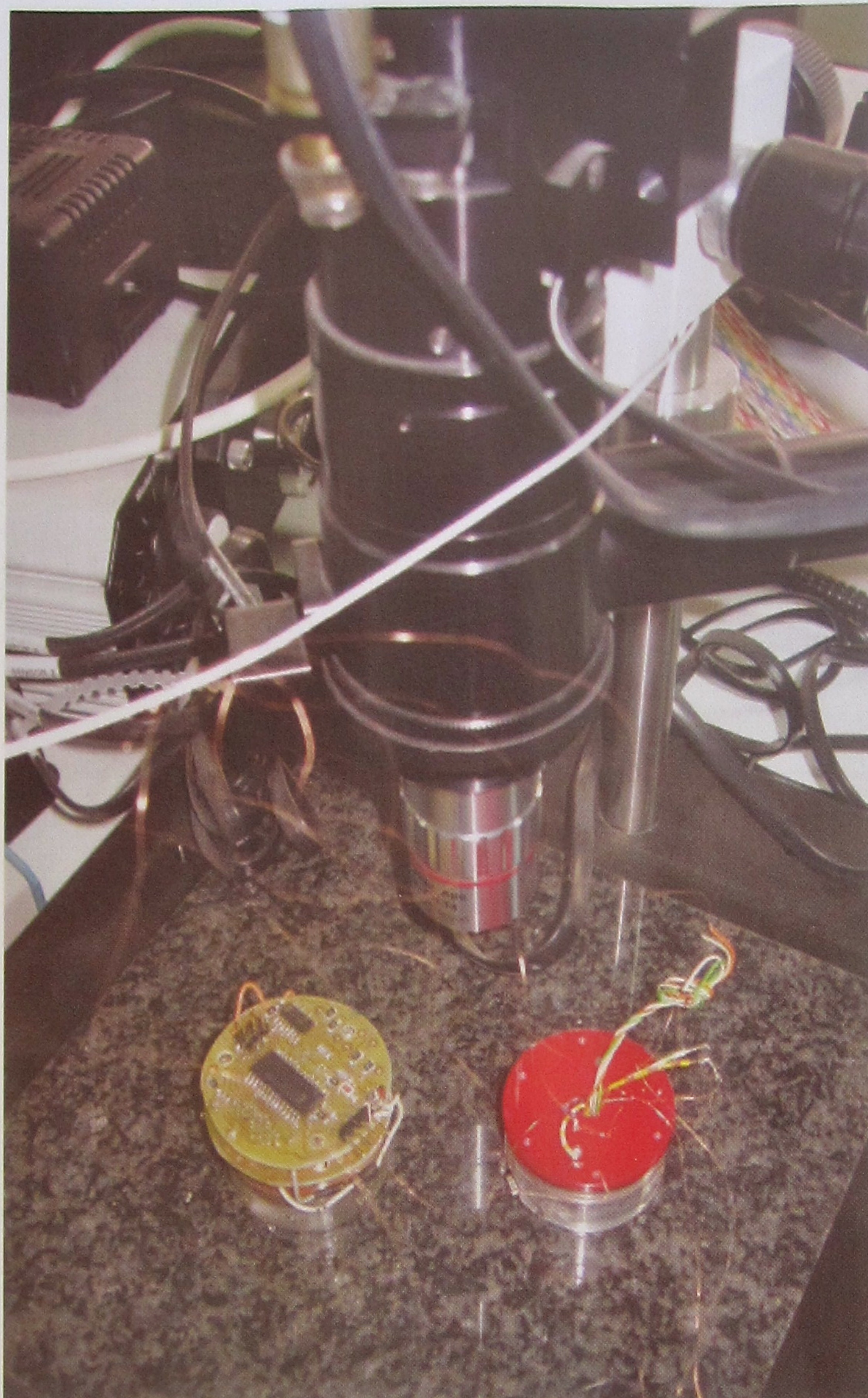
Δύο μικρορομπότ στο φυσικό περιβάλλον εργασίας τους. Κινούνται επάνω σε τράπεζα από γρανίτη και κάτω από βιντεομικροσκόπιο. Η εικόνα που δίνει το μικροσκόπιο εμφανίζεται σε οθόνη υπολογιστή και μπορεί να χρησιμοποιηθεί για να οδηγήσει τη βελόνα των μικρορομπότ στο επιθυμητό σημείο.
